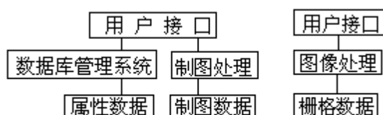
图6-4 通过软件接口实现地理信息系统和遥感的结合（据 Manfred Ehlers）
